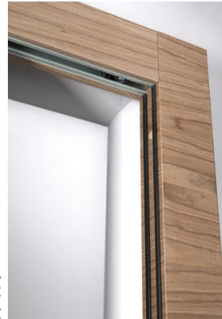
Tablo è disponibile anche in versione scorrevole esterno muro. L'anta piena tamburata di spessore 46 mm con maniglia di trascinamento ad incasso, binario di scorrimento metallico incassato nella trave superiore in legno, dotato di 'fermo porta' ammortizzato. La versione scorrevole, a richiesta, può essere valorizzata dall'inserimento di un montante di battuta complanare a trave e pannello completo di guarnizioni in materiale plastico.
